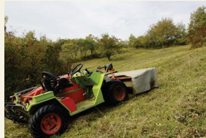
Auf steileren Flächen ist Traktormahd oft nicht mehr möglich, hier kann ein Metrac helfen.
